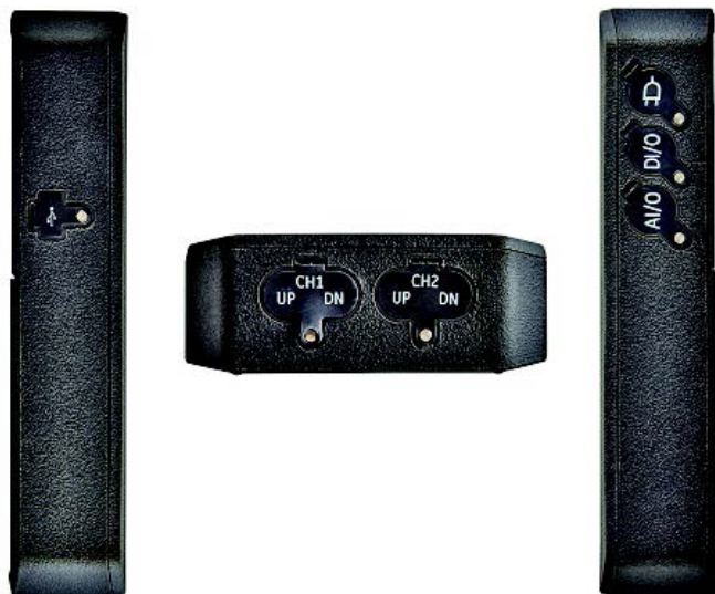
Conexiones eléctricas del transmisor
