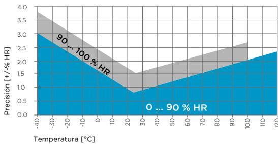
Precisión en la medición de la humedad de HMP9 como función de temperatura (incluidas la no linealidad y la repetibilidad)
