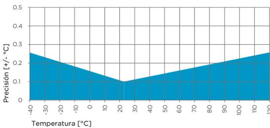
Precisión en la medición de la temperatura de HMP9 sobre el rango completo (incluidas la no linealidad y la repetibilidad)
