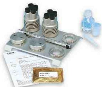
*Calibrador de humedad en sal HMK15*
