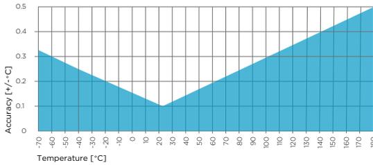
Precisión de TMP1 en la medición de temperatura sobre el rango completo
