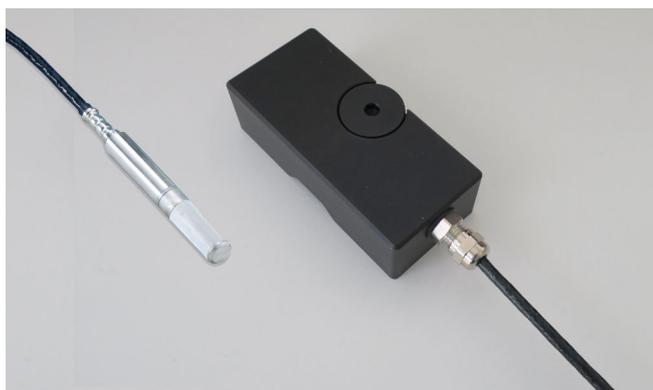
La sonda HMP373 de tamaño pequeño encaja en espacios reducidos: se muestra conectado con un cable de teflón
