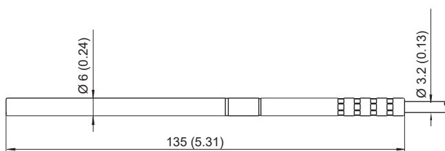
HMT337 T Dimensiones en mm (pulgadas)
