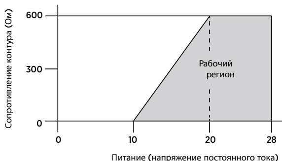
Рис. 50 Рабочий диапазон напряжения питания HMDW110
