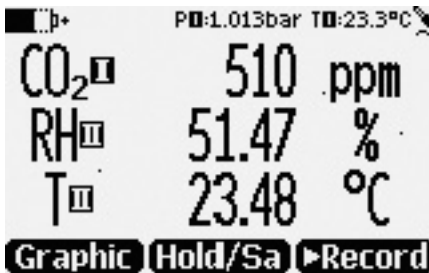
図 10 二酸化炭素と温度および湿度プローブを同時に接続した表示例
