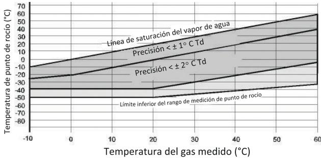
Precisión (sonda A) de -40 a +60 °C  $\pm 2^\circ\text{C}$  ( $\pm 3,6^\circ\text{F}$ ) (consulte el gráfico)
